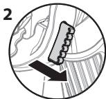
Détente débloquée (le pistolet pulvérise)
